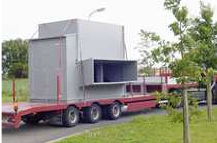
Vervoer luchtwassermodule naar een veehouderij (Bron: Uniqfill Air B.V.)
